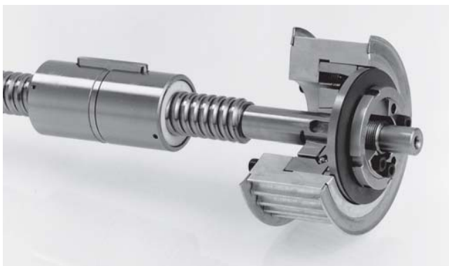
Husillo de recirculación de bolas con acoplamiento de seguridad tipo SKG para transmisiones indirectas.
